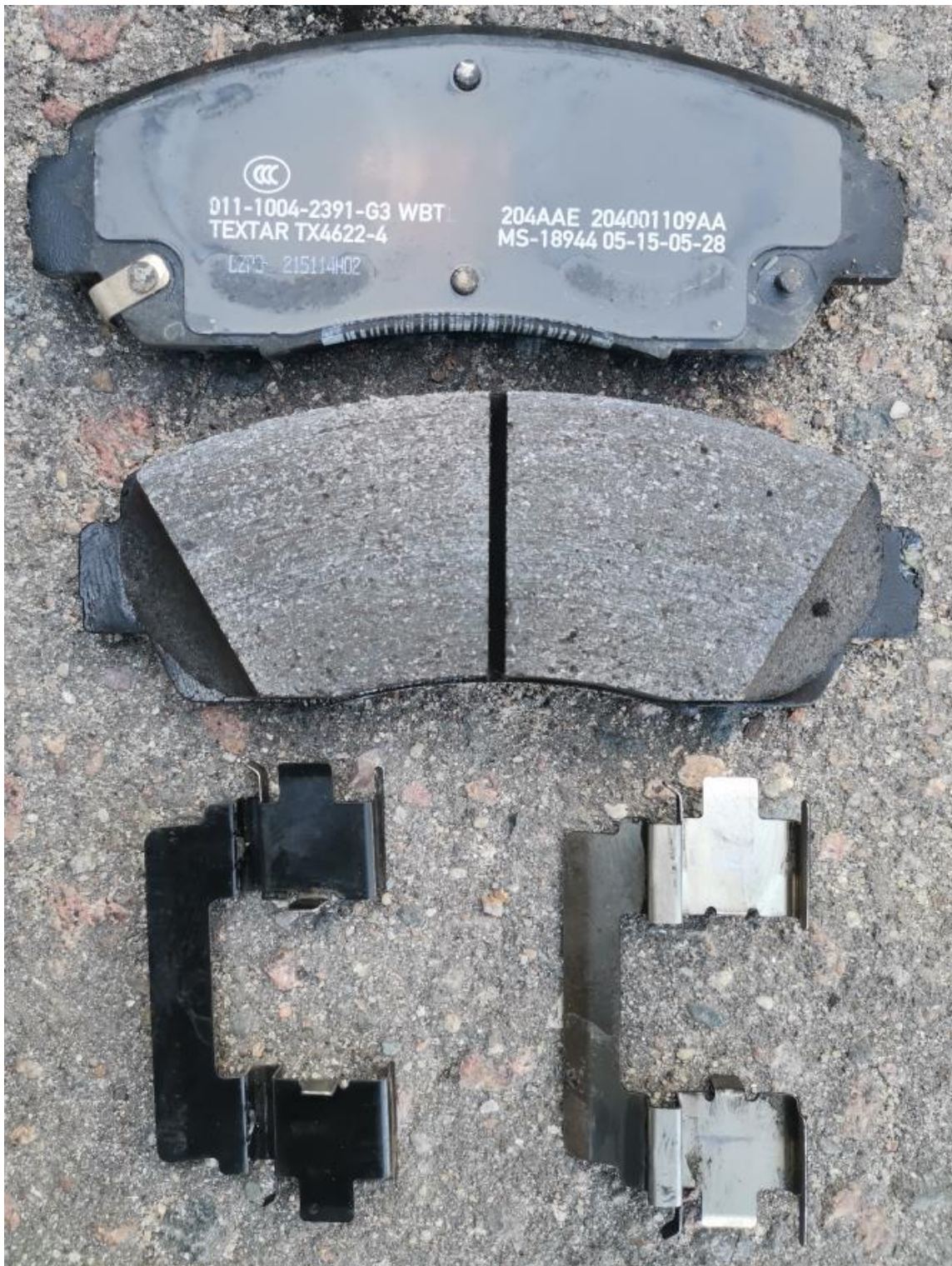
Фото: устанавливаемые колодки и монтажные пружины.
